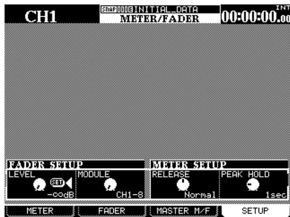
**Livello dei fader** Il POD 1 permette di modificare il livello dei fader (LEVEL) tra  $-\infty$  e -36 dB, in 128 variazioni.
