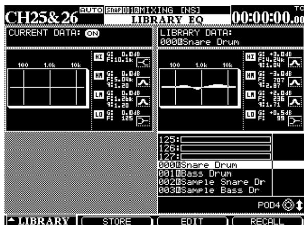
Oltre alla rappresentazione grafica della curva d'equalizzazione per la regolazione corrente e quella salvata, in questa schermata si vedono i valori numerici relativi a guadagno, frequenza e fattore Q per ciascuna delle quattro bande di equalizzazione.
