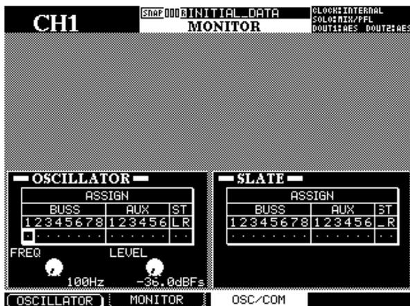
I quattro tasti nella riga inferiore del display, vicino ai POD, si utilizzano come "tasti soft" e controllano direttamente le "pagine" indicate. Nel nostro esempio, le pagine MONITOR e OSC/COM sono controllate dai tasti soft 2 e 3.
