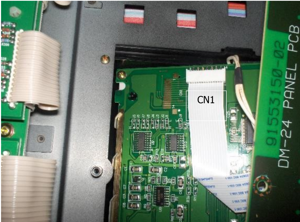
Figure 6 -- Display PCB -- CN1
